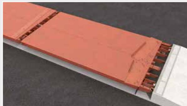
**Piano di carico in lamiera lobata**, con funzione "anti-sdruciolamento", particolarmente importante in caso di superficie bagnata, sporca o con rampe di salita. La particolare lobatura inoltre evita il ristagno dell'acqua sul piano.
