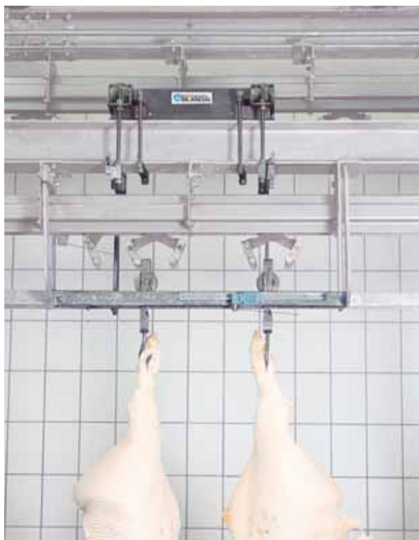
Pesatura automatica in una linea di macellazione
